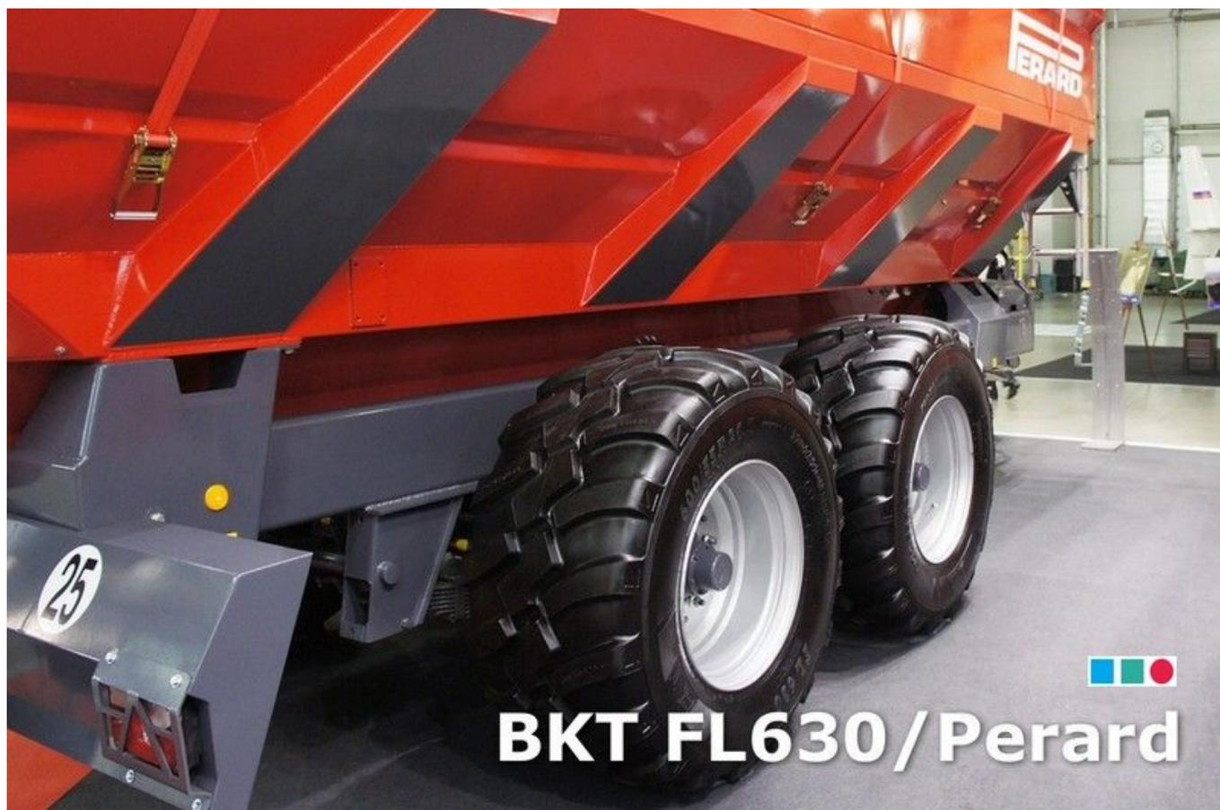
Радиальная шина флотационного и транспортного типа
