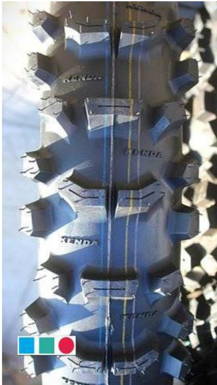
Шина КЕНДА К 782 при резком открытии газа не зарывается вглубь мягкого грунта, а выталкивает мотоцикл вперед. Мне очень понравилась покрышка KENDA K782 Sand-Mad на песчаном треке - позволяет проходить повороты на газу, ехать по глубоким песчаным колеям, перерезать колеи в нужном направлении - везде уверенное сцепление с трассой.
