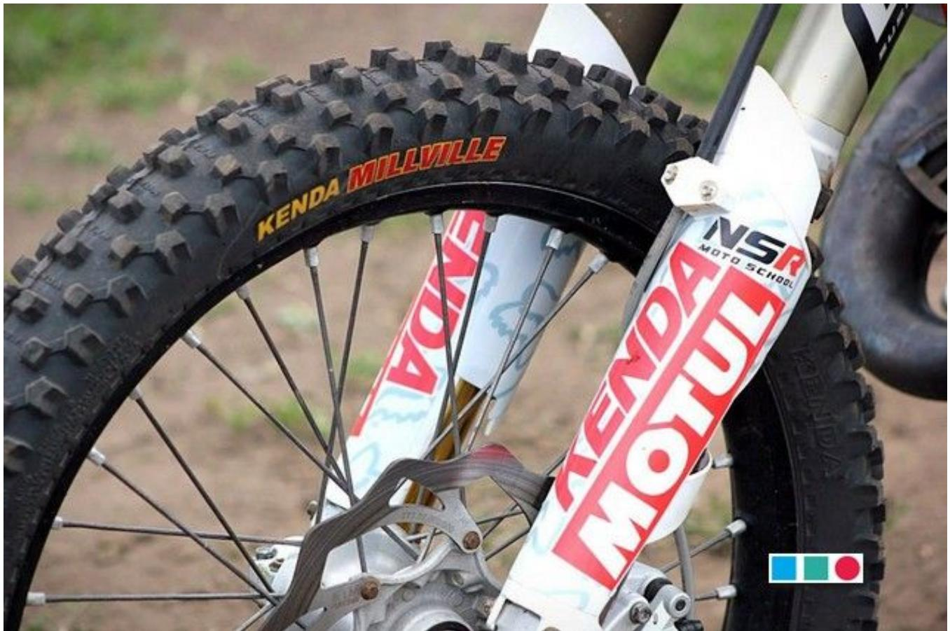
Сразу отмечу универсальность этой шины — она имеет направленный рисунок протектора в обе стороны: для мягкого и более твердого грунта. Если ставить К771 на мягкий грунт — шипы будут расположены в форме "лопатки", что позволяет отлично контролировать мотоцикл на мягких трассах. Если же развернуть покрышку в обратную сторону — шикарный зацеп на твердом грунте гарантирован.
